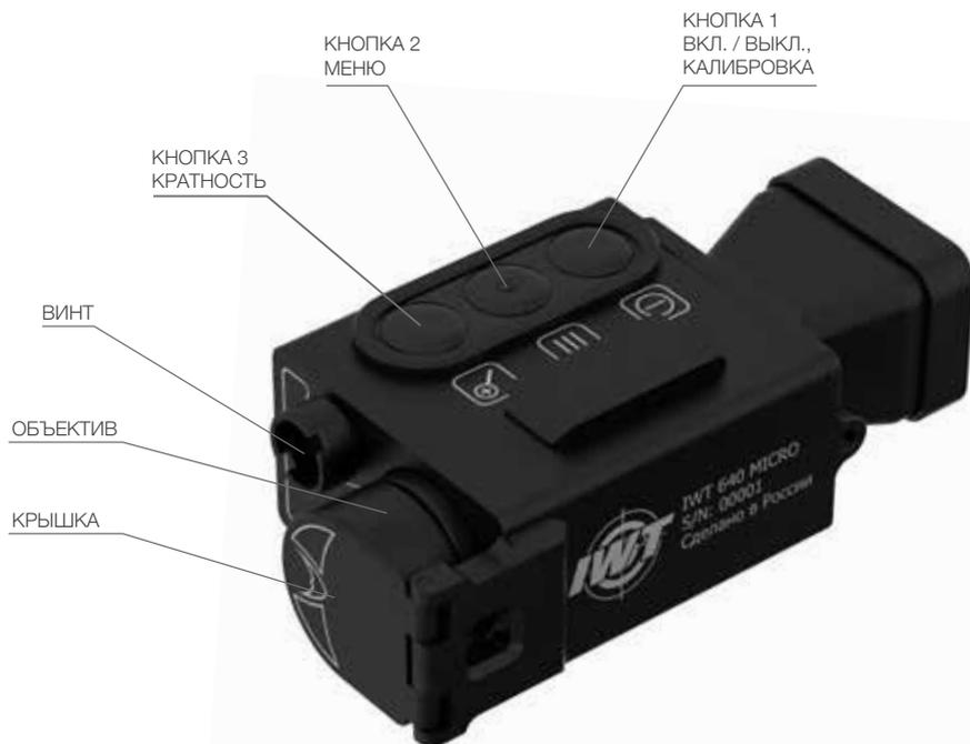
Перед использованием тепловизионного прибора или разряде элемента питания установите батарейку CR123A в батарейный отсек. Для этого открутите ВИНТ, указанный на рисунке, отсоедините защитный кожух от основного корпуса, установите элемент питания. При установке соблюдайте полярность:
